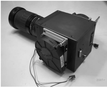
图 6 风冷摄像机系统实物照片
