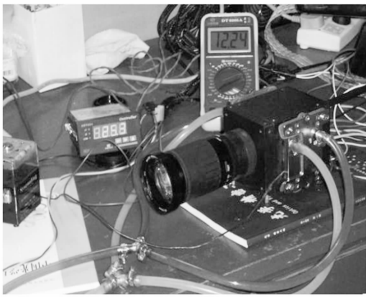
图 7 液冷摄像机系统实物照片
